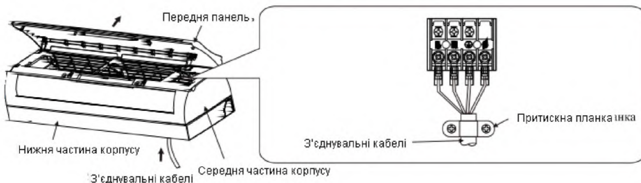
Схема електричного підключення – постійний струм
