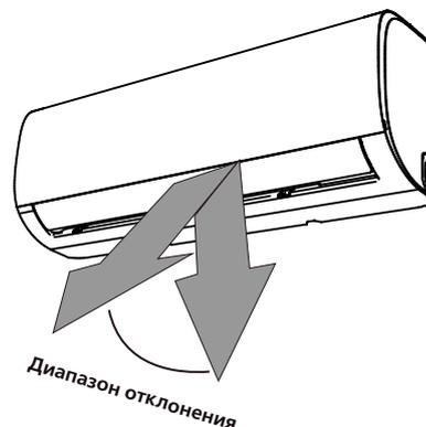
**! Осторожно!** Не задавайте вертикальный угол отклонения жалюзи, близкий к отвесному, на длительное время. Это может вызвать образование капающего конденсата.
